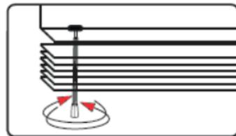
Para regular a inclinação das lâminas, girar o bastão de acrílico.
